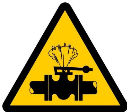
PELIGRO DE PROYECCIÓN DE LÍQUIDO A ALTA PRESIÓN
